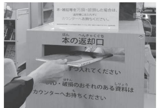
【返却の場合】カウンター脇に返却専用箱が設置されています。その返却口へ本を1冊ずつ滑り込ませることで返却が完了します。この返却口にはICタグ読み取りの機械が入っており、資料が通過すると自動で読み取って返却済となるため、資料は必ず1点ずつ滑り込ませる必要があります。
