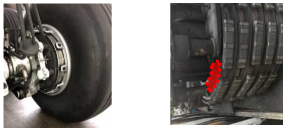
正常なブレーキ ブレーキ板が一部欠落
