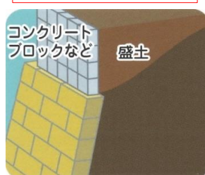
継ぎ足し擁壁
