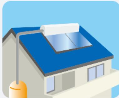
太陽の熱エネルギーを太陽集熱器に集め、熱媒体を暖め給湯や冷暖房などに活用するシステム
