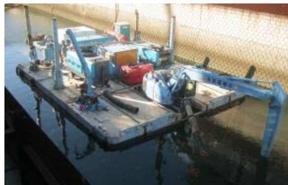
写真 2.5 高濃度式ポンプ浚渫船
