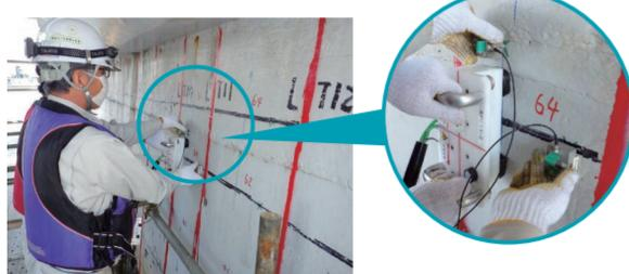
最新の非破壊検査である電磁パルス法により腐食を発見
