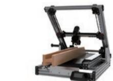
ベルトコンベア式3Dプリンター「Leee」。コンベア式にすることで長尺や連続の造形が可能に
