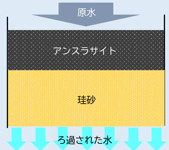
図4 ろ過処理(アンスラサイト+珪砂)
