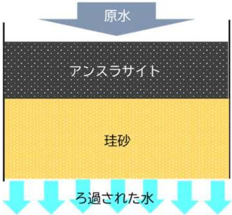
図1 ろ過のイメージ (アンスラサイト+珪砂)
