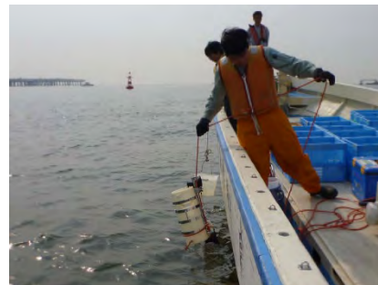
海中の水質を検査するため、専用の機材を使用して採水します。
