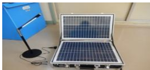
ソーラー式蓄電池
