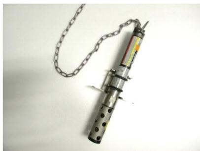
図7 水質連続測定装置（多項目水質計 W-22XD）
