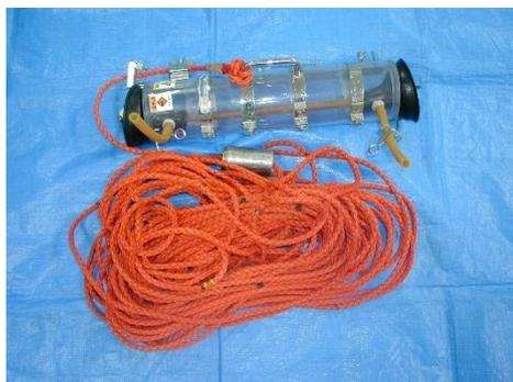
図 2 バンドーン型採水器
