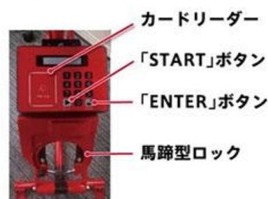
図 4-6 IC カード対応の自転車
